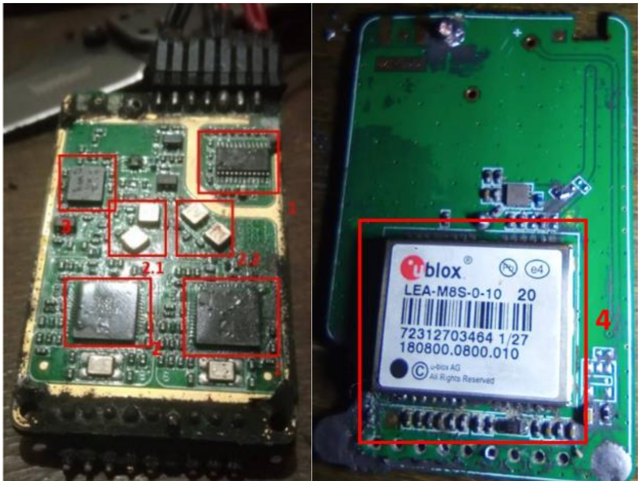
Рисунок 1.3 – Зовнішній вигляд плат блоку командно-телеметричної системи з системою навігації: а) плата трансивера КТРЛ б) плата з модулем супутникової навігації.
