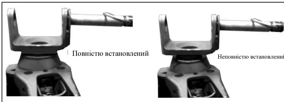
Малюнок 4-6. Штифт M205 повністю та не повністю встановлений
